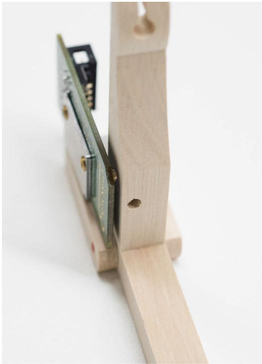
Positionierung des Sensors am Trakturwinkel. Die Polung des Magneten in der Bohrung des Trakturwinkels spielt keine Rolle. Sie wird bei der Einrichtung des Pedals automatisch erkannt.
