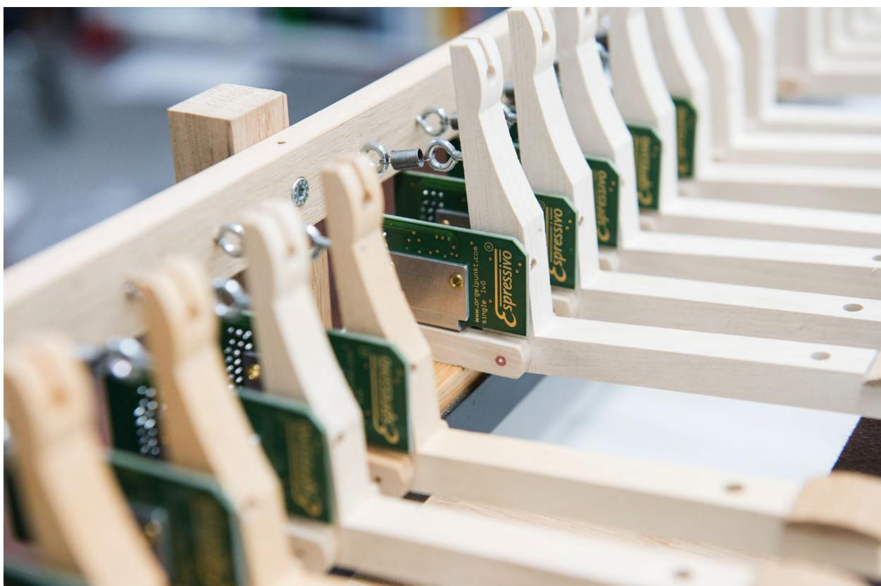
(hier mit Stoppleisten und Rückholfedern zur Traktursimulation)
