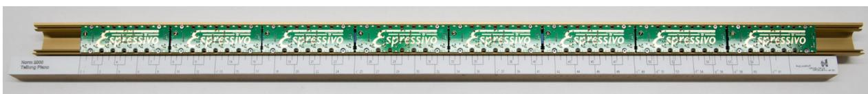
In diesem Zustand kann die Funktion der Leiste bereits überprüft werden. Dazu verbindet man sie mit dem Master Modul (s.unten) und schaltet das System ein. Die Kontroll-LED jedes Moduls (im Espressivo-E) blinkt beim Einschalten für ca. eine Sekunde lang.
