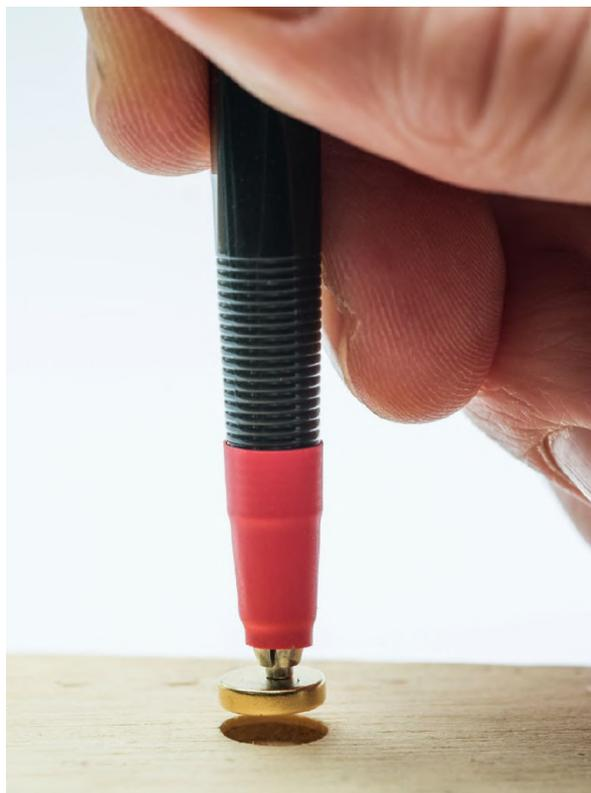
Die korrekte Ausrichtung der Magnete lässt sich leicht mit dem Montgestift (rote Spitze) sicherstellen. Der Stift enthält an seiner Spitze einen magnetischen Nordpol. Da sich gegensätzliche Magnetpole anziehen, haftet ein Klaviaturmagnet stets mit dem Südpol am Stift.
