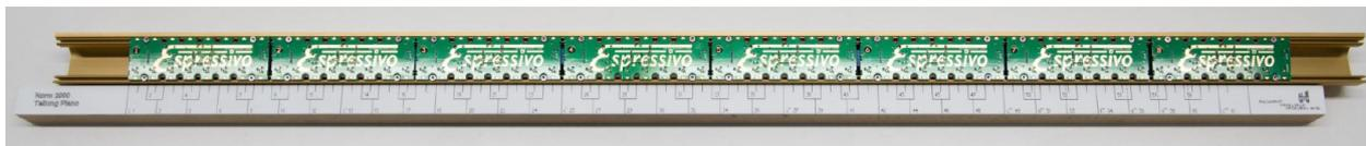
In diesem Zustand kann die Funktion der Leiste bereits überprüft werden. Dazu verbindet man sie mit dem Master Modul (s.unten) und schaltet das System ein. Die Kontroll-LED jedes Moduls (im Espressivo-E) blinkt beim Einschalten für ca. eine Sekunde lang.
