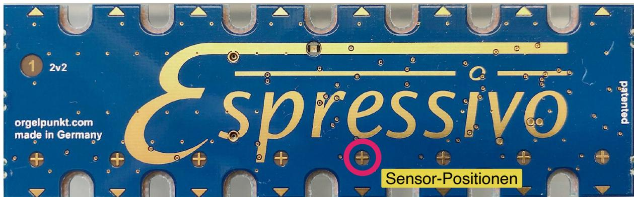
Um unterschiedliche Manualumfänge auszurüsten, können ein oder mehrere Sensorplatine an den Markierungslinien auf der Bauteilseite gekürzt werden. Benutzen Sie dazu eine Schlagschere oder eine Metallsäge. Die Schnittstellen sollten möglichst glatt sein (wenn nötig mit der Feile nachbearbeiten), um Kurzschlüsse von getrennten Leiterbahnen zu verhindern.
