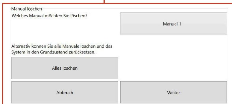
Unter Umständen kann es notwendig werden ein bereits eingerichtetes Manual zu löschen und noch einmal komplett neu einzurichten und zu kalibrieren. Das ist der Fall, wenn ein Manual bereits mit einem anderen Mastermodul eingerichtet worden war.
