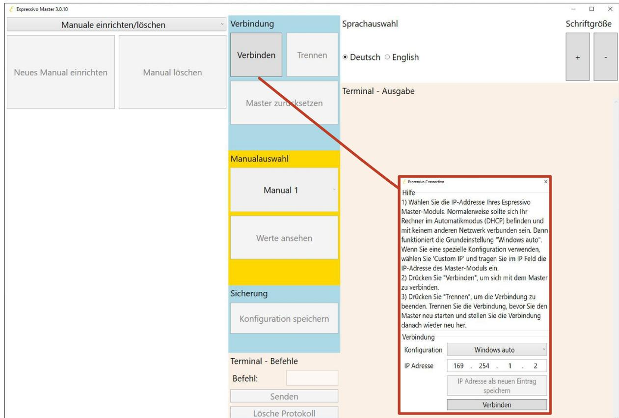
Überprüfen Sie die IP-Einstellung und stellen Sie mit der Schaltfläche „verbinden“ die Verbindung zum Master-Modul her:
