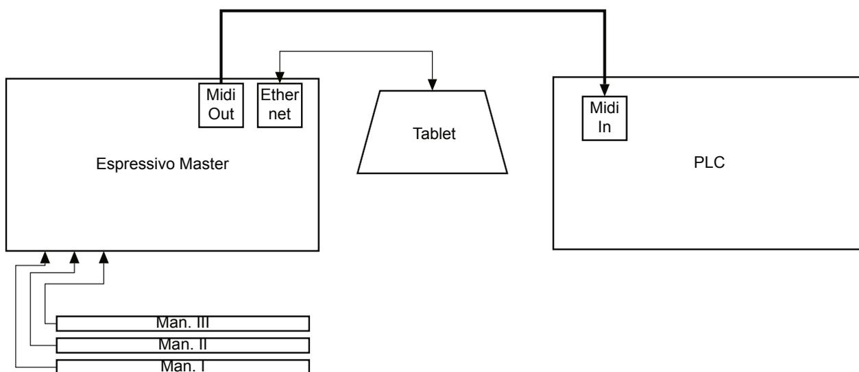
Wenn Sie die Ethernet-Schnittstelle benutzen, um Trakturdaten an das Orgel-Steuersystem zu senden, sollten Sie diese Verbindung über einen Ethernet-Switch führen.
