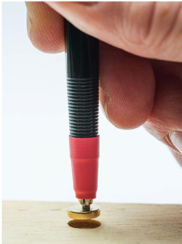
Die korrekte Ausrichtung der Magnete lässt sich leicht mit dem Montagestift (rote Spitze) sicherstellen. Der Stift enthält an seiner Spitze einen magnetischen Nordpol. Da sich gegensätzliche Magnetpole anziehen, haftet ein Klaviaturmagnet stets mit dem Südpol am Stift.
