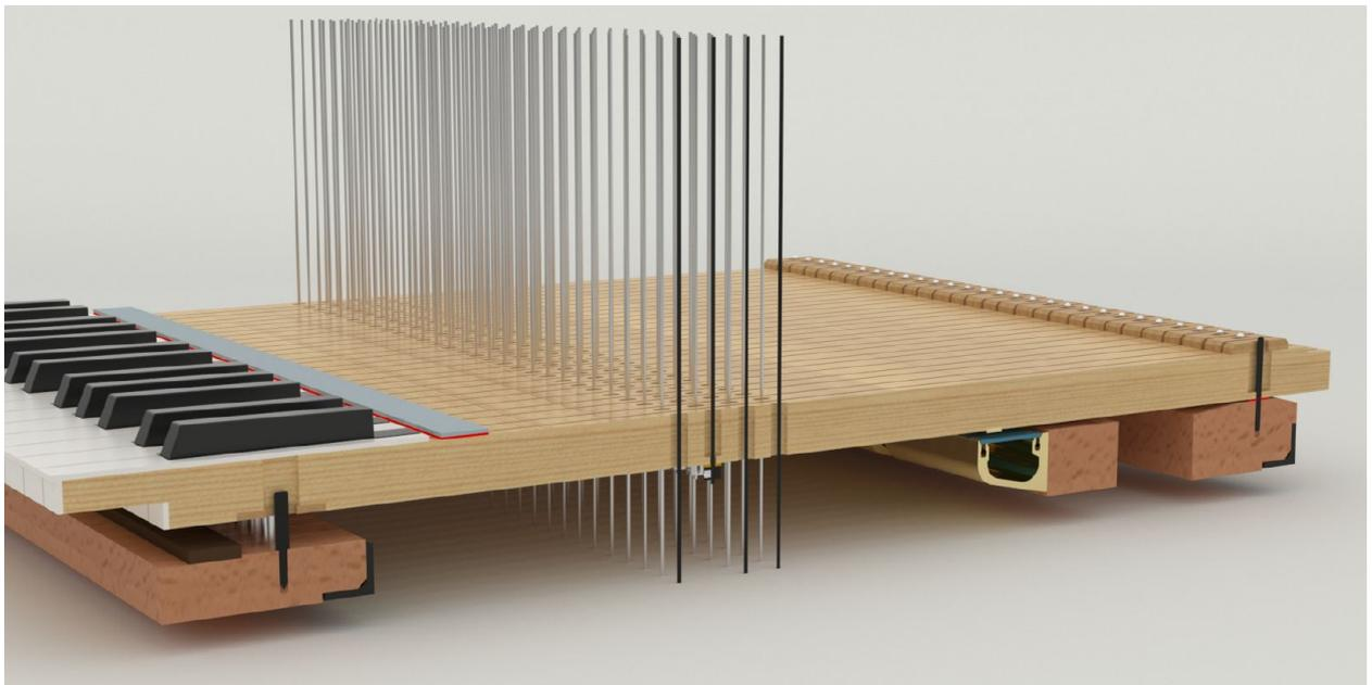
Klaviatur für hängende mechanische Traktur, mit montierter Espressivosensorleiste an einem zusätzlichen Balken vor dem Waagbalken.
