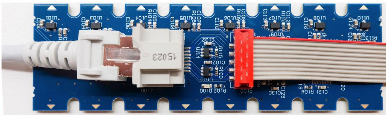
Modul 1 enthält die RJ45-Buchse (Ethernetkabel) zur Verbindung mit dem Master. Am einfachsten ist die Montage am Ende der Sensorschiene, so dass das Verbindungskabel jederzeit im eingebauten Zustand gesteckt werden kann.
