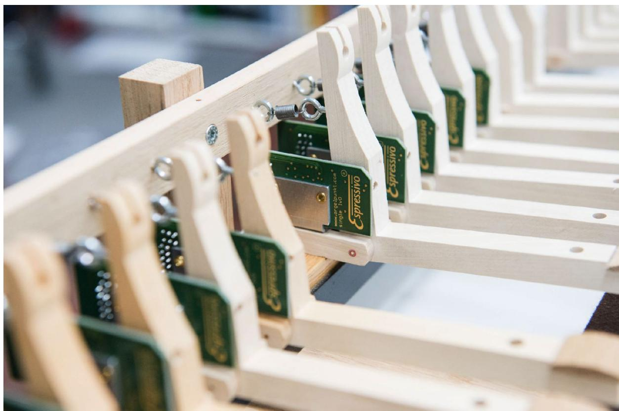
(hier mit Stoppleisten und Rückholfedern zur Traktursimulation)
