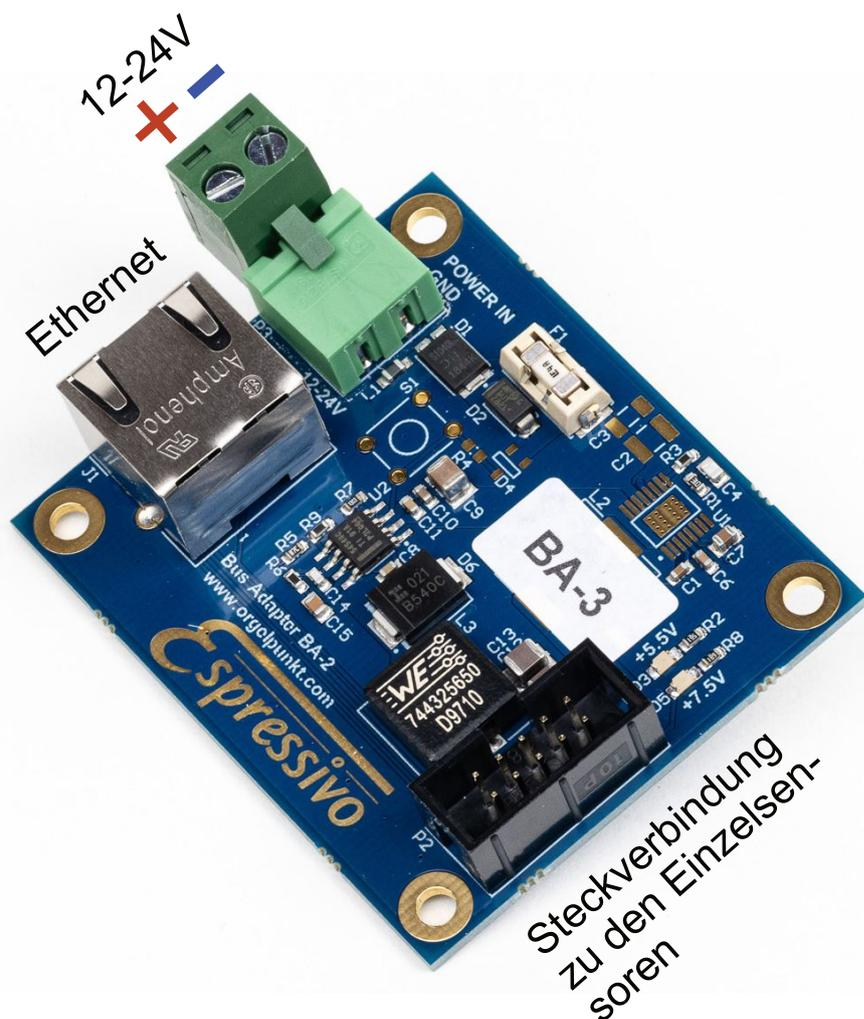
Der Pedalkontaktstock benötigt eine eigene Spannungsversorgung. Schließen Sie den Busadapter BA-2, BA-3 oder BA-4 über die steckbare Versorgungsklemme an dasselbe Netzgerät (12 - 24V) an, das auch den Espressivo-Master versorgt. Grüne LED zeigen die Funktion der Versorgungselektronik auf dem Busadapter an.
