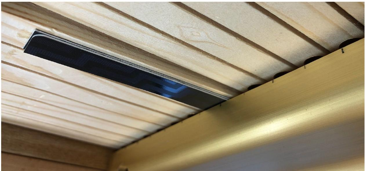
Bei niedergedrückter Taste sollte zwischen Sensorleiste und Tastenunterseite kein unnötig großer Abstand eingestellt werden. Ideal sind 1,5mm. Dies lässt sich einfach mit einem Abstandhalter aus zwei übereinander geklebten Kreditkarten-Streifen feststellen.
