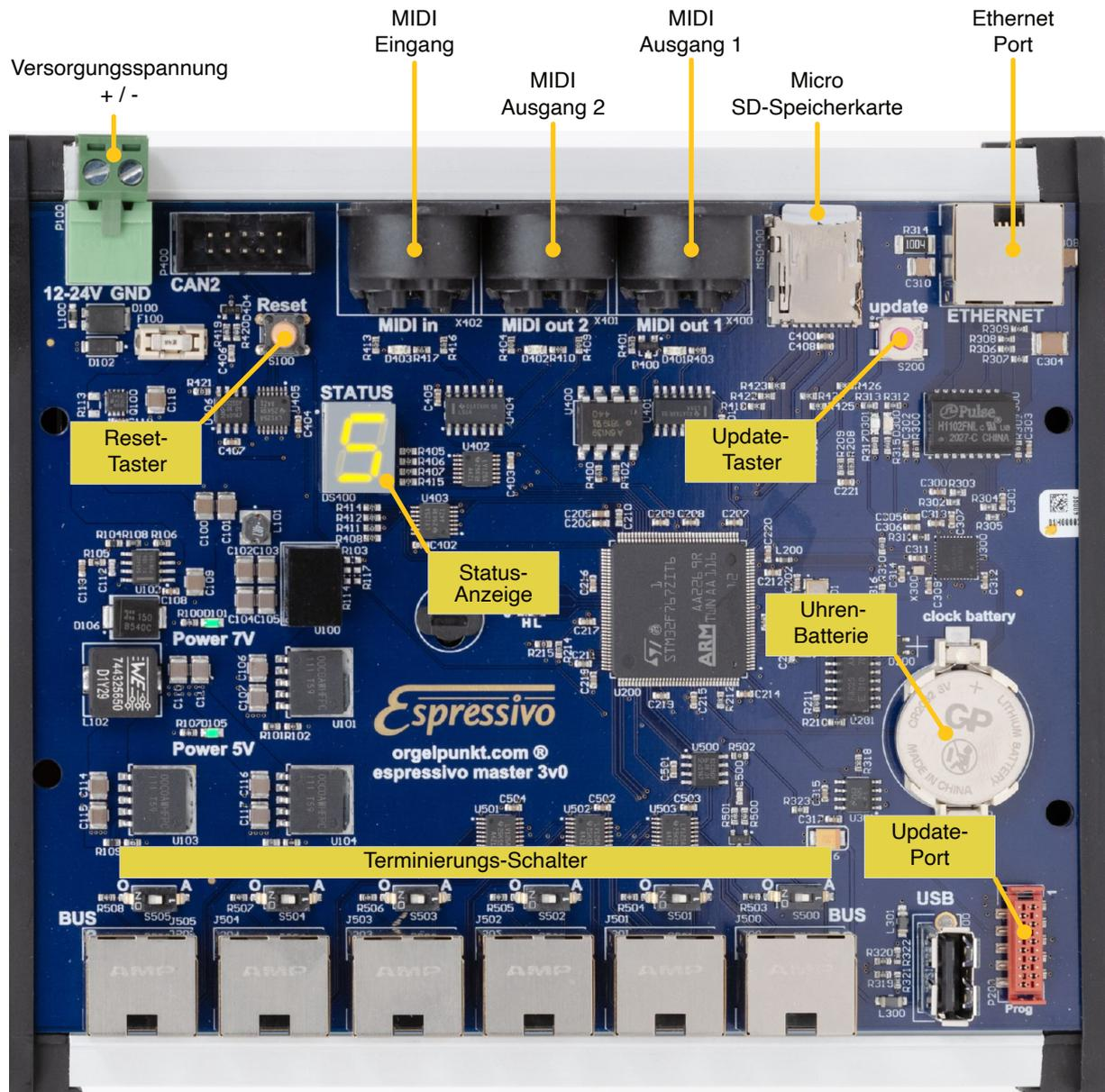
Bis zu sechs Manual-Sensorleisten und zwei Stränge mit Einzelsensoren können an das Mastermodul angeschlossen werden. Es versorgt die Sensormodule mit Strom, wertet die Daten aus und erzeugt die Midisignale zur Steuerung von elektrischer Traktur oder anderer Tongeneratoren.
