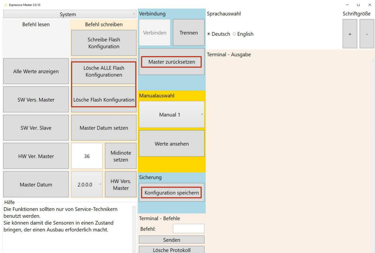
Das Löschen der Flashkonfigurationen ist über die Funktion „System“ zugänglich.
