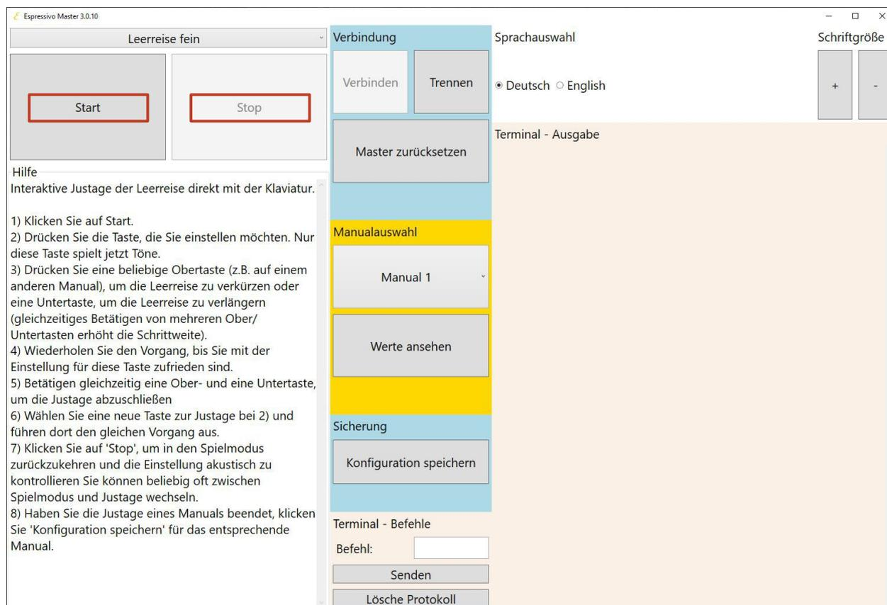
Mit dieser Funktion können Sie jederzeit im eingebauten Zustand einzelne Tasten unter ständiger Tonkontrolle nachregulieren. So lassen sich mechanische und elektrische Traktur perfekt synchronisieren. Auch ist dies der bevorzugte Modus, um nach Gefühl und Gehör individuelle Einstellungen vorzunehmen, um etwa den Toneinsatz dem Spielgefühl einer Druckpunktsimulation anzugleichen.
