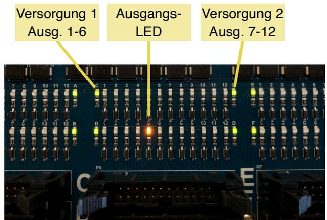
umfassende Anzeigen für Einspeisesicherungen und Ausgangsstatus
